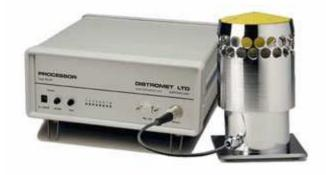
O pulso gerado pela gota esta relacionado pela amplitude U em Volts e o diâmetro da gota D em mm incidente.
