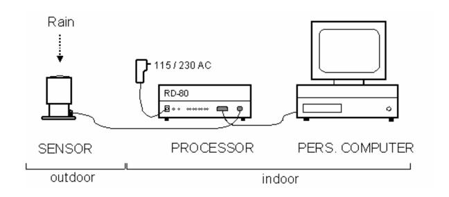
Este instrumento tem a característica de medir a distribuição de tamanho de gotas de chuva (DSD ou RDSD) através de um espectrômetro eletromecânico, onde as gotas incidem sobre uma área de 50 cm<sup>2</sup>.
